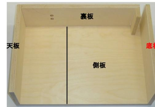
ボンドが硬化するまでに「L定規」もしくは「三角定規」で正しく直角になっているか確認します
