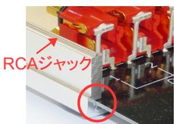
基板をアルミケースの「スリット(溝)」に挿し込みます(RCAジャック側から)
