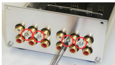
RCAジャック固定ネジ(M2.6×8)でリアパネルと基板を固定します(4カ所)。その後、ゆるめになっていたパネル取付ネジを最後まで締め付けます
