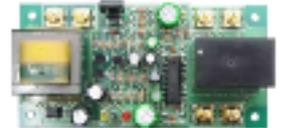
このユニットでは予め抵抗とコンデンサによる調整で約15秒間で動作するようになっています。
