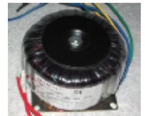
18. トロイダルトランスを取り付けます。(2個)
