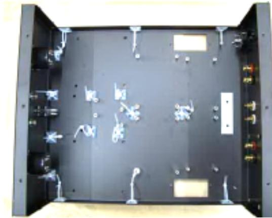
12. R(右)チャンネルのスピーカー端子の配線をします。
