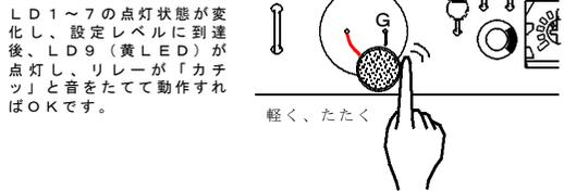
LD1~7の点灯状態が変化し、設定レベルに到達後、LD9(黄LED)が点灯し、リレーが「カチッ」と音をたてて動作すればOKです。
