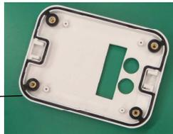
基板に合わせて、ふたを取り付けて、ひっくり返して、ケースに付属しているねじで4箇所ねじどめしてください。
