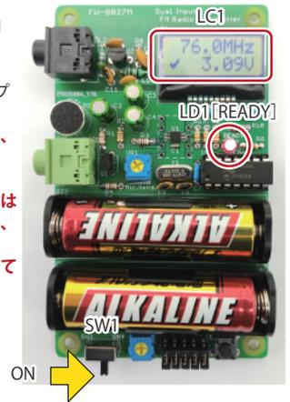
5. お手持ちのFMラジオ受信機の電源を入れ、選局(チューニング)を76.0MHzに合わせて、本キット基板を1~2m程度の距離に近づけてください。
