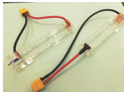
15. 使用する充電器に合わせて コネクタを取り付ければ完成です！
