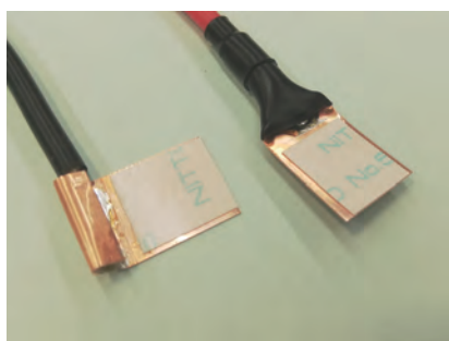
13. ホルダーへの貼り付けスペースに、 カットした両面テープを貼り付けます。
