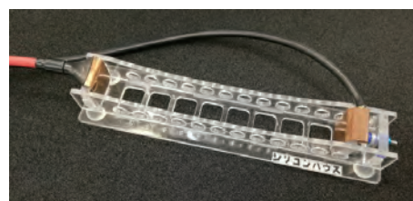
14. 銅板を C、EF に両面テープで貼り付けます。 ＋の極性は好みですが、 C 側を＋にした方が使いやすいと感じました。
