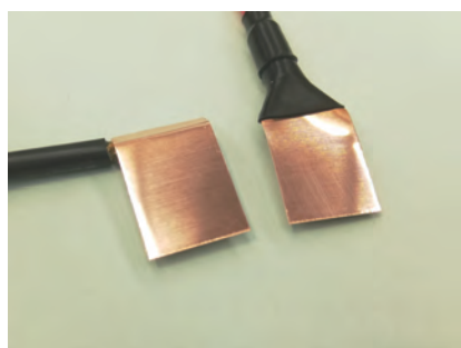
12. ケガ防止や絶縁のために、 端子を丸めたり、熱収縮チューブで カバーをしておきます。
