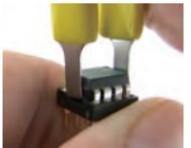
注意: ICソケットの足を曲げないよう、抜き挿しのときは無理をせず、少しずつ作業を進めてください
