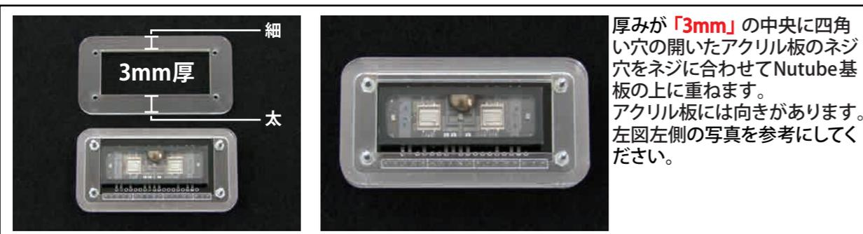
厚みが「3mm」の中央に四角い穴の開いたアクリル板のネジ穴をネジに合わせてNutube基板の上に重ねます。アクリル板には向きがあります。左図左側の写真を参考にしてください。
