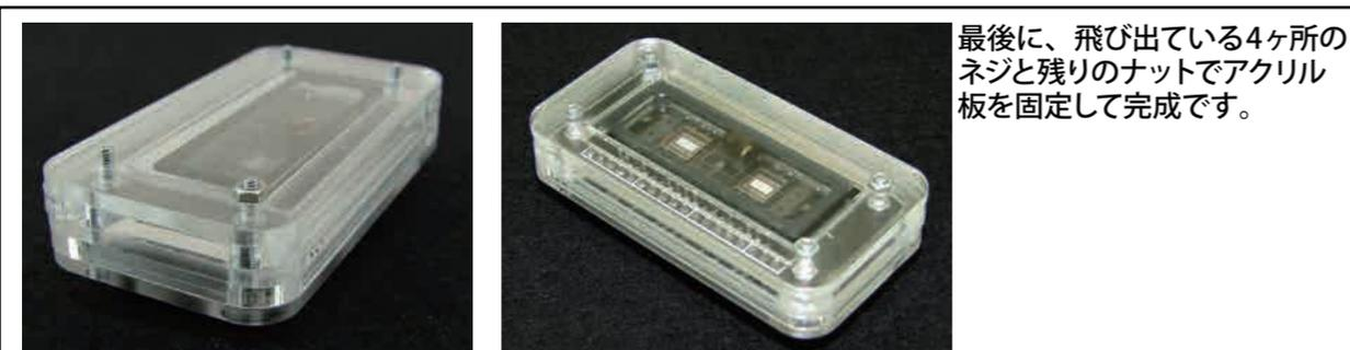
最後に、飛び出ている4ヶ所のネジと残りのナットでアクリル板を固定して完成です。
