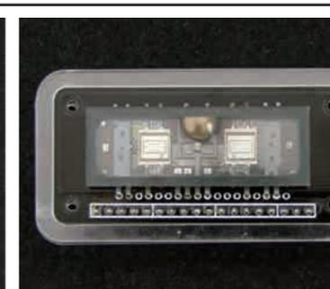
枠型のアクリル板をNutube基板の上に重ねます。
