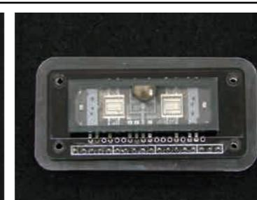
山型に穴の開いたアクリル板の上に、Nutubeを実装した変換基板(以後、Nutube基板)を重ねます。アクリル板は方向がありますので左図左側の写真を参考にしてください。
