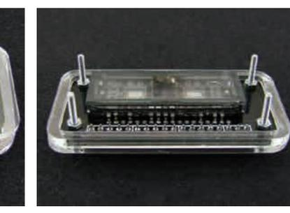
付属のネジとナットで下側のアクリル板とNutube基板を固定します。ネジはNutube基板のヘッダーピン側からネジ穴に差し込み、計4ヶ所を固定してください。
