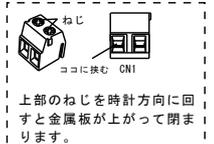
上部のねじを時計方向に回すと金属板が上がって閉まります。
