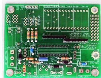
◆**ICソケット、ボリューム、セラミック発振子を実装する**
