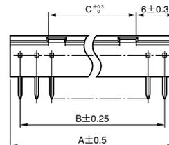
基板取付穴寸法(参考・装着面)
