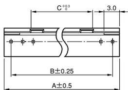
基板取付穴寸法(参考・装着面)
