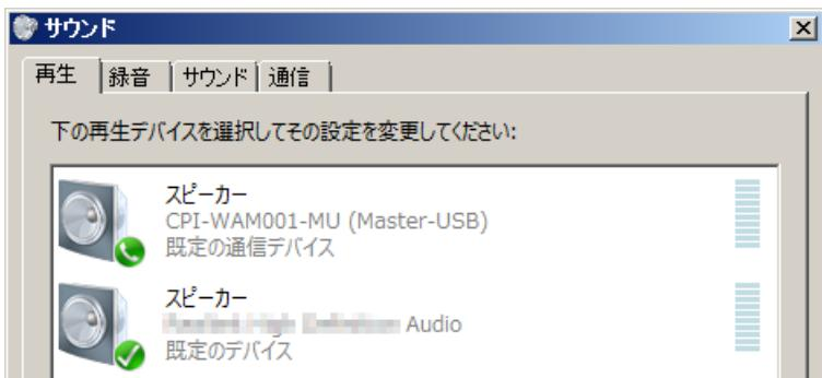
2. 「スピーカー CPI-WAM001-MU (Muster-USB)」の項目を右クリックすると、以下のような画面になるので、「既定のデバイスとして設定(D)」を選んで、左クリックします。
