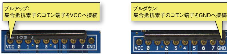
図6 TB2の抵抗素子の取り付け例（プルアップ / プルダウン）
