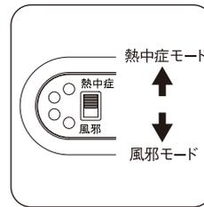
スイッチをスライドさせて測定モードを切替えます。
