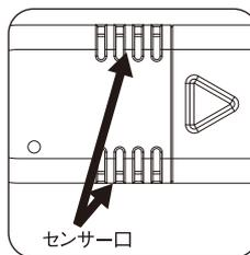
本体の横にある穴(センサー口)から外気を取り込み、温度と湿度を検知しますので通気の良い所でご使用ください。
