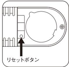
電池蓋内部のリセットボタンを爪楊枝などで押してください。それでも表示が異常な時は電池の消耗が考えられますので電池を交換してください。
