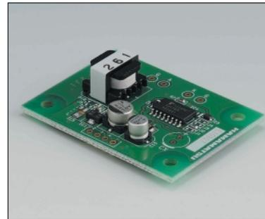
浜松ホトニクスでは、R2868の駆動回路C10807シリーズも取り扱っています。1枚のプリント基板上に、高圧電源と信号処理回路を内蔵していますので、UV tronを接続しただけで高感度の炎センサとして動作させることができます。詳しくはC10807シリーズのカタログを参照してください。
