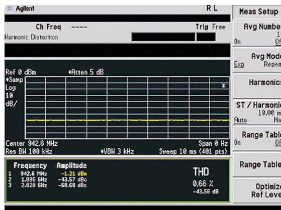
1 GHzでの歪んだCW信号の高調波の測定
