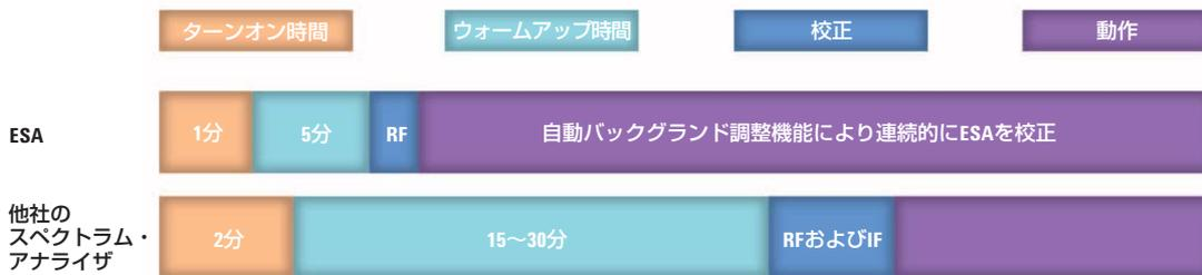
最先端のバックグラウンド調整機能による5分間のウォームアップ時間
