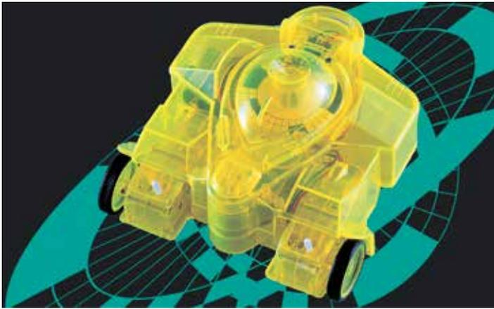
デジタルロボットはフォトセンサを使って回転するディスクの明暗を読み取り、左右のモータを回転させたり停止させたりしながら、自在に進むことができます。また、デジタルロボットは、自由にプログラムディスクを作ることもできます。
