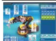
簡単なコマンド入力で5つのモータの動作をプログラムして実行します。
