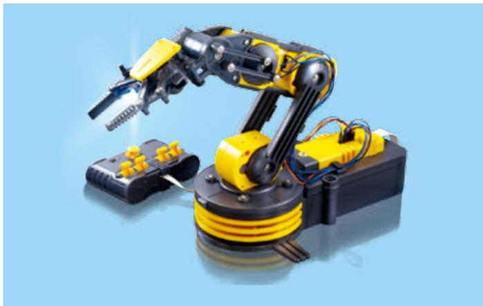
基本的なロボット技術の学習と、5つのモータ・5つの関節を持つあなただけの有線リモコン型ロボットアームを作ることができます。5チャンネルコントローラで、ロボットは旋回、持ち上げ、ひじまたは手首や、機能的なグリップを使った動作を行います。5つのモータで、つかむ、放す、持ち上げる、下ろすの動作を行います。また、搭載しているサーチライトで、暗い場所での操作も楽しめます。
