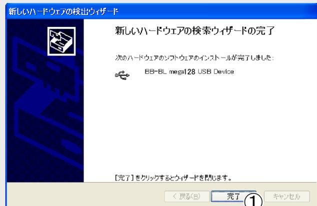
USBドライバ(BB-BL mega128)の設定完了後、自動的にデバイスドライバ(USB Serial Port)の設定に入ります。
